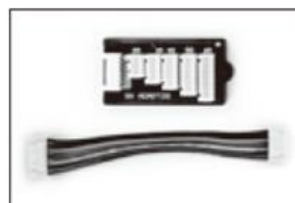
#44152 ¥600(税抜) バランス変換ボード (JST-XH(タマゾー、ALIGN、 JACK/パワー タイプ))
