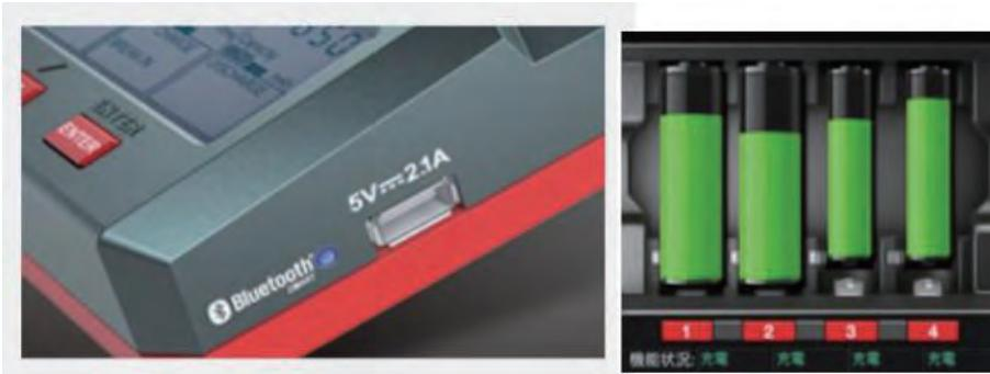
⑦アプリ起動後は本体へ充電式電池をセットして、スマートフォン側の表示と連動しているかなどで通信状態や動作の確認をします。
