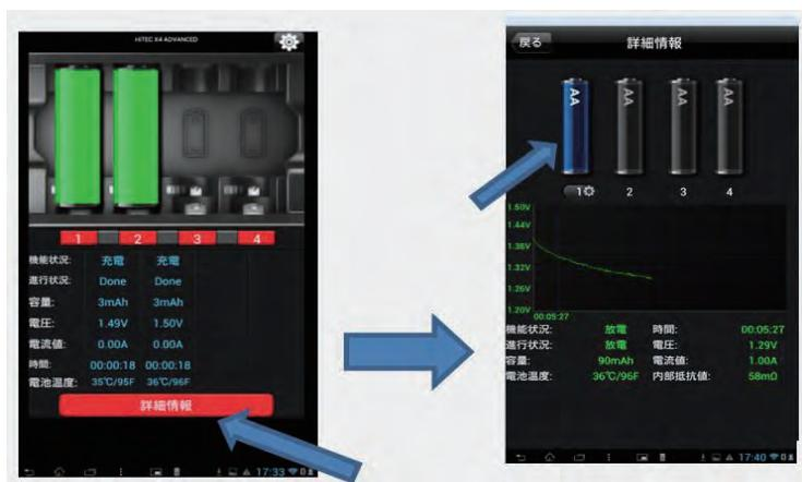
注意 グラフ表示は充電器との通信が途切れてしまった後、再接続した場合、再接続が開始された時間を基準に表示されます。
