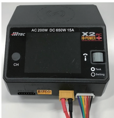
Li-Po (リチウム系) の接続時 (CH2)
