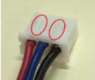
LiPo2セルのバランスコネクタ ○印部が突起部
