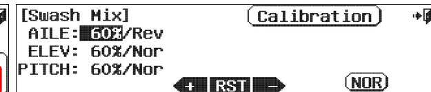
●上の調整ではバランスがとれない場合、「Calibration」で各サーボの細かいカーブを7ポイントで調整できます。
