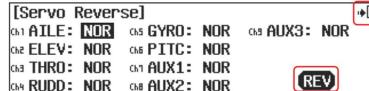
希望するチャンネルをタッチして「REV」アイコンで方向を設定します。確認アイコンが出ますので「Yes」をタッチします。完了したら「EXIT」アイコンで画面を抜けます。
