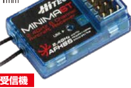
横挿しタイプ 超小型フルレンジ受信機
