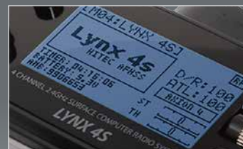
バックライト付きフルドット大型LCDスクリーンを採用。
