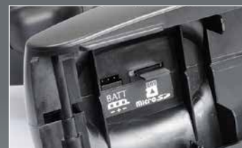
Micro SDカードスロットを装備、WAVE音楽ファイルの再生が可能。電源投入時やアラーム他サウンドをSDカード内の音源ファイルで再生可能。
