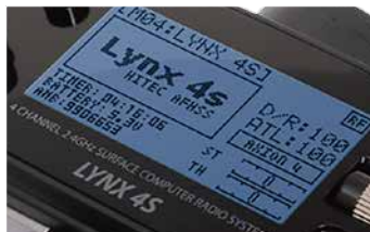
バックライト付きフルドット大型LCDスクリーンを採用。
