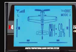
● 送信機の液晶ディスプレイにはブルーバック ライト装備、操作した舵をディスプレイに表示
