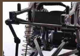
■リアサス上部のトーションバーで車体 のねじれを抑制
