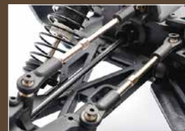
■調整式フロントサスペンションアーム でキャンバー角やトール角を変更可能
