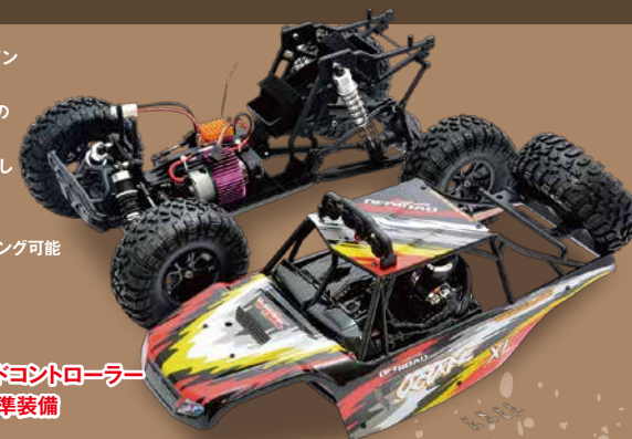
■リアサス上部のトーションバーで車体 のねじれを抑制
