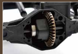
■リアデフへのアクセスは4本のピスを 外すだけで完了
