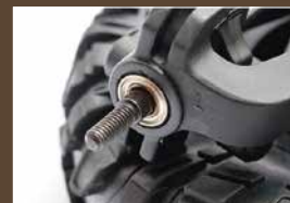
■駆動系にボールベアリング標準装備 でキャンバー角やトール角を変更可能
