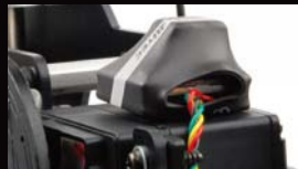
④ HTS-GPS (GPSセンサー) 緯度経度、高度、速度が計測可能なGPSセンサーです。あらゆる機体姿勢でもGPSが受信できるように5面アンテナを採用したPC専用製品。PCを使えば飛行軌跡の記録も可能です。 測定範囲: 高度/0~9,000 速度/0~900km/h
