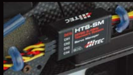
⑨ HTS-SM (サーボマネージャー) サーボの電流値を個別に計測。サーボの負荷の状態や必要なBEC容量の確認を容易にし、電圧低下による作動不良の回避に役立ちます。 測定範囲: 0~10A (4ch) 計測単位: 0.1A
