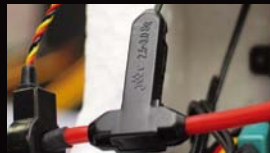
⑧ HTS-VOLT (電圧センサー) 飛行中の動力用バッテリーの電圧が測定可能な電圧センサーです。現在値、最高、最低値が送信機側で表示可能で、設定した電圧まで下がるか送信機側のアラームで通知します。リボの過放電や電圧低下による作動不良を防ぐ事が可能です。 測定範囲: 0 ~ 100V 計測単位: 0.1V
