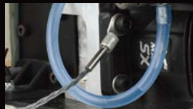
③ HTS-E TEMP (エンジン温度センサー) エンジン温度が測定できるセンサーです。エンジンマウントなどに共締めする仕様のため、簡単に装着できます。
