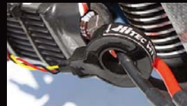
⑦ HTS-C50/C200 (電流センサー) 動力用バッテリーの電流値が計測できるセンサーです。簡単に使えるクランプメータータイプ。現在の電流値に加え最大、最低値も表示、任意の電流値に設定可能なアラームも装備。電圧センサーとの組み合わせでワット数も表示可能になります。
