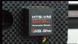
⑤ HTS-VM (バリオメーターセンサー) 気圧を計測して機体が上昇しているか下降しているかを知らせてくれる気圧計。上昇率、下降率や、サマルなどの情報も送信機側で確認できます。グライダー等に最適です。 計測範囲: 0~6,000m(海拔高度) 0~+2,000m(相対高度)
