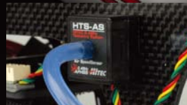
⑥ HTS-AS (対気速度センサー) GPSセンサーが対地速度(Ground Speed)を計測するのに対し、機体と大気(空気)との相対速度を、機外のパイプを通して計測できるセンサーです。 計測範囲: 0~900Km/h
