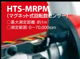
② HTS-MRPM (マグネット式回転数センサー) ○最大測定距離: 約1m ○測定範囲: 0~70,000rpm
