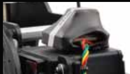
⑤ HTS-GPS (GPSセンサー) 緯度経度、高度、速度が計測可能なGPSセンサーです。あらゆる機体姿勢でもGPSが受信できるように5面アンテナを採用したRC専用製品。PCを使えば飛行軌跡の記録も可能です。 測定範囲: 高度 0~9,000 速度 0~900km/h
