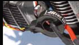
⑧ HTS-C50/C200 (電流センサー) 動力用バッテリーの電流値が計測できるセンサーです。簡単に使えるクランプメータータイプ。現在の電流値に加え最大、最低値も表示、任意の電流値に設定可能なアラームも装備。電圧センサーとの組み合わせでワット数も表示可能になります。
