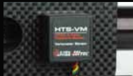
⑥ HTS-VM (バリオメーターセンサー) 気圧を計測して機体が上昇しているか下降しているかを知らせる気圧計。上昇率、下降率や、サーマルなどの情報も送信機側で確認できます。グライダー等に最適です。 計測範囲: 0~6,000m(海拔高度) 0~+2,000m(相対高度)
