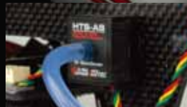
⑦ HTS-AS (対気速度センサー) GPSセンサーが対地速度(Ground Speed)を計測するのに対し、機体と大気(空気)との相対速度を、機外のパイプを通じて計測できるセンサーです。 計測範囲: 0~900Km/h
